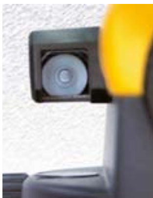
Pentaprismă pentru citirea simplă a nivelei cu bulă.
